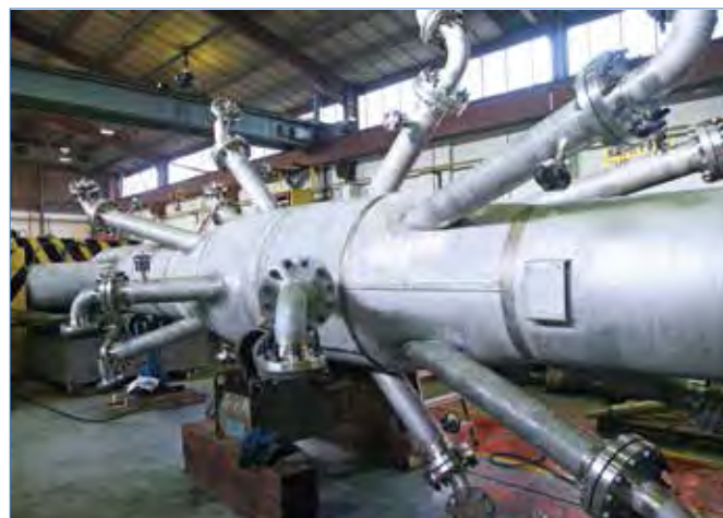
Tenuta in acciaio inossidabile 321H
