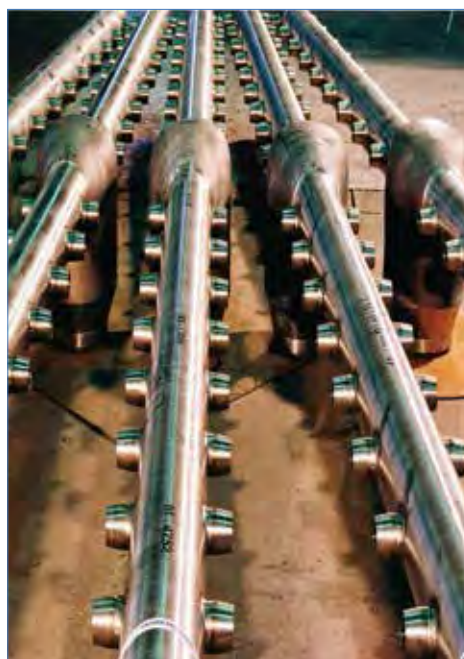
Collettori di aspirazione in Incoloy 800HT
