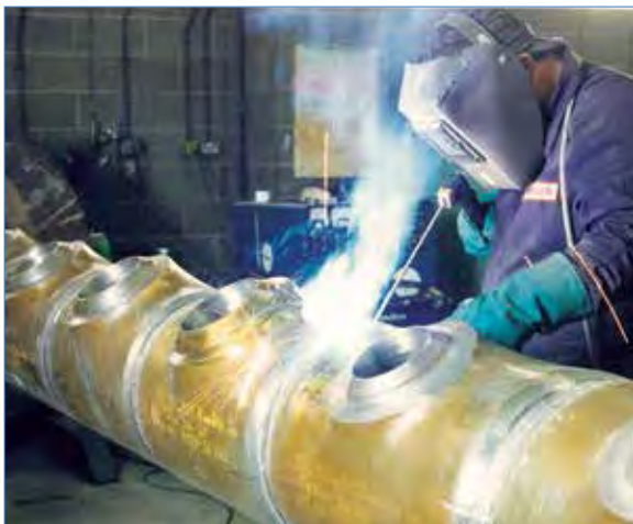
Il primo collettore per testa di pozzo bimetallico al mondo, rivestito in X65 con lega 825
