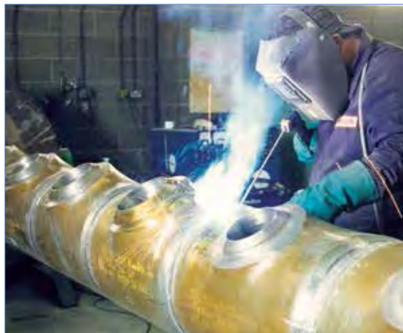
Primeiro poço de tubulação bimetálico do mundo revestido com X65 com liga 825
