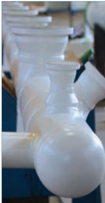
El primer colector en cabezal de pozo bimetálico de X65 revestido con aleación de 825
