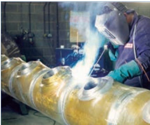
El primer colector en cabezal de pozo bimetálico de X65 revestido con aleación de 825
