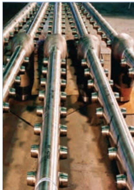
Colectores de entrada en aleación Incoloy 800HT
